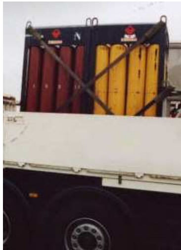
Fotos: Die Verladung gefährlicher Güter im Straßenverkehr: Hier Gasflaschen (Mitte) und ein IBC (rechts). Die Kennzeichnung des Fahrzeuges mit orangefarbenen Tafeln ist vorgeschrieben.
